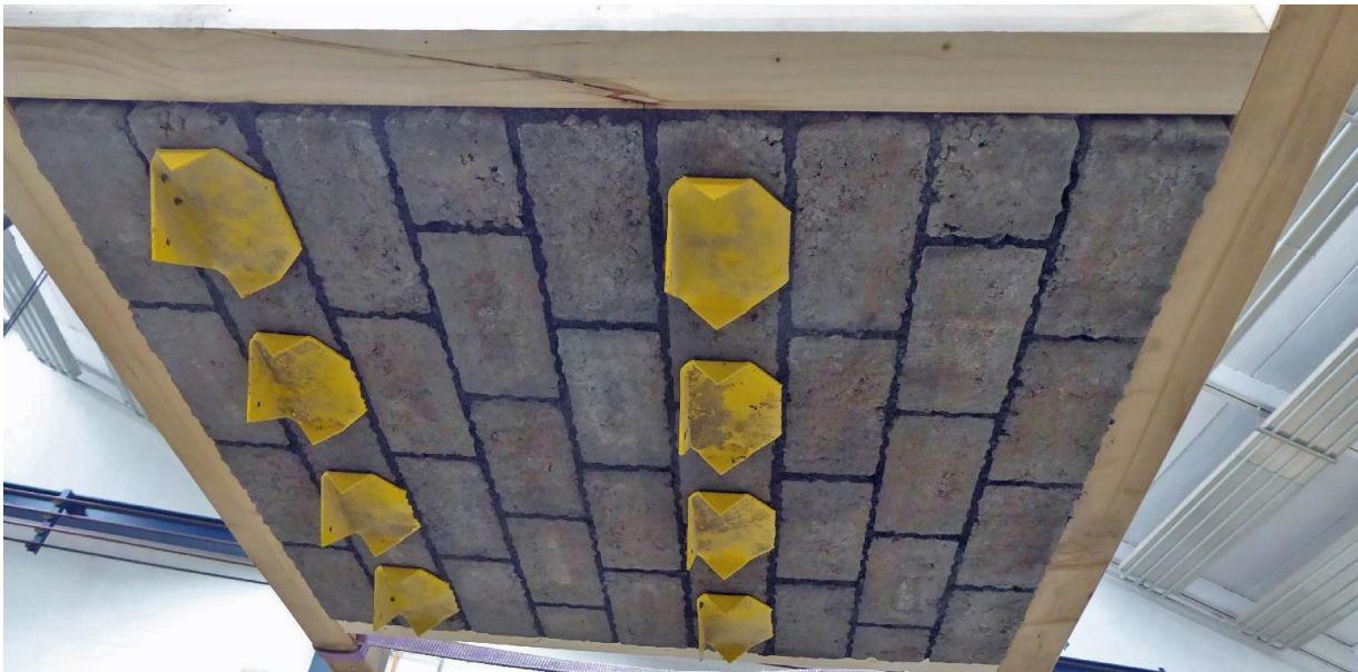
Bild 6: Orientierung der Erdanker
